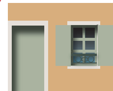
Les ferronneries sont en vert très sombre. Leur ton respecte la famille de couleur dominante des volets (ici le vert).
