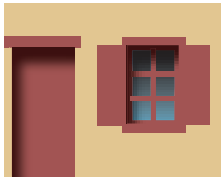
Porte, fenêtre, volets, encadrement, linteau et appui bois identiques.
